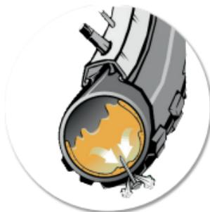
6. Befestigen Sie die Decke in der Felge. Achten Sie darauf, dass der Schlauch nicht zwischen Felge und Decke eingeklemmt ist.
